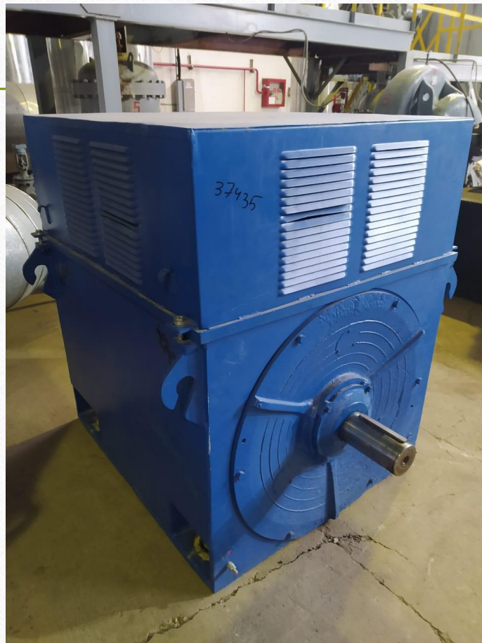
2.5 Электродвигатель переменного тока А4- 450Х-6УЗ
